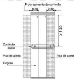
Figura 80 – Corrimão intermediário com duas alturas em degrau isolado com dois degraus em planta – Exemplo
