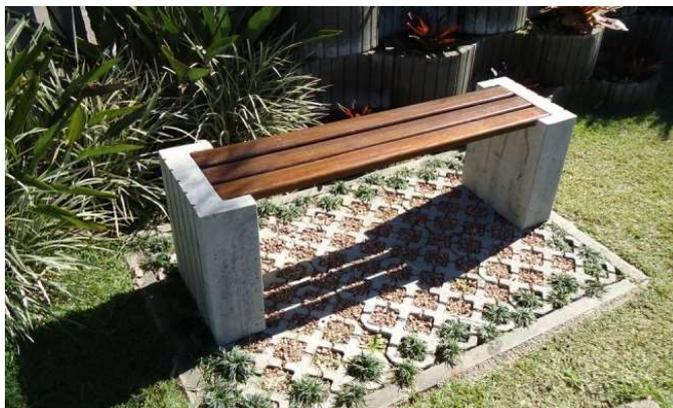
**7.2** No estar central serão instalados bancos curvos, conforme detalhe em projeto. Os bancos serão em concreto com assento em madeira tratada e certificada própria para área externa. Estes serão fixados no contrapiso do Calçadão conforme detalhe.
