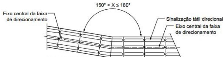
Figura 46 – Mudança de direção  $150^\circ < X \leq 180^\circ$
