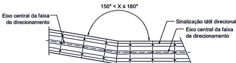
Figura 46 – Mudança de direção  $150^\circ < X \leq 180^\circ$
