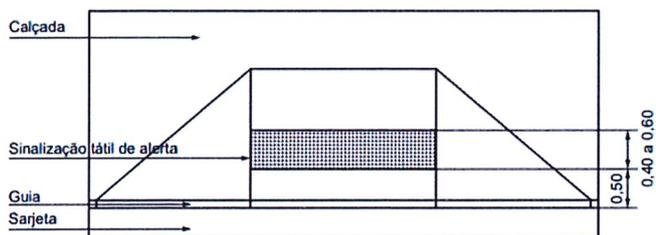
Figura 22 – Rebaixamento de calçada sem rampas complementares
