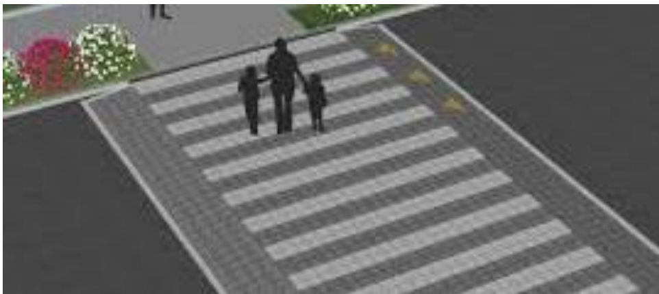
Faixa elevada deverá ser executada com blocos grafite (cinza escuro) conforme imagem e nas listras com bloco intertravado branco.
