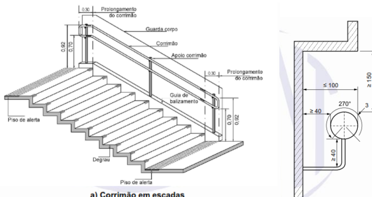
a) Corrimão em escadas
