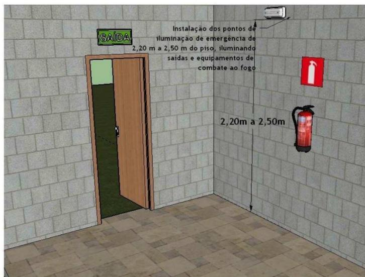
Deverão ser instaladas 06 unidades de bloco autônomo, conforme localização em planta. Prever instalação de tomadas para as luminárias de emergência, tanto na parte da Ampliação quanto na parte existente.
