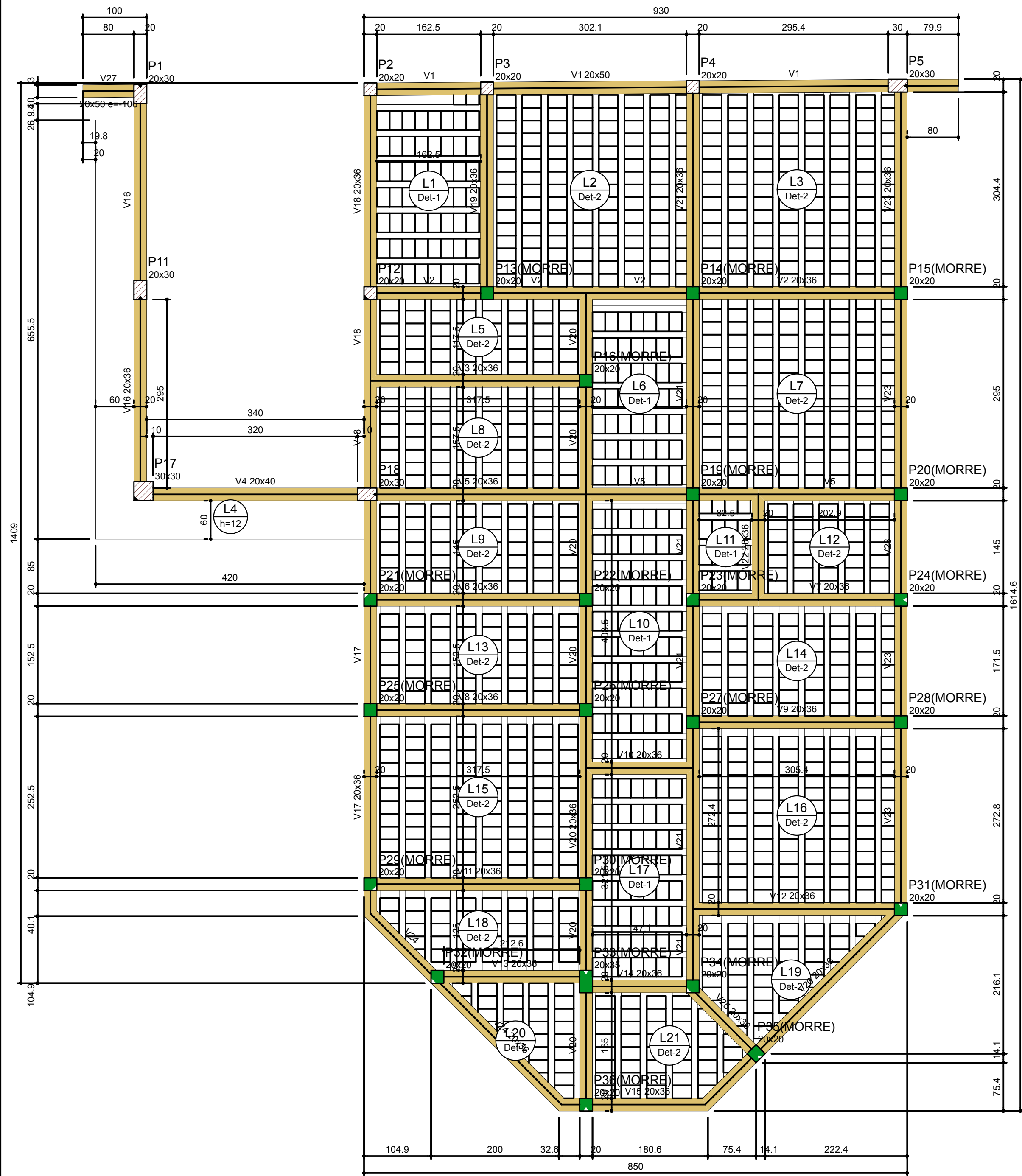
Forma do Pavimento Laje Cobertura escala 1:50
